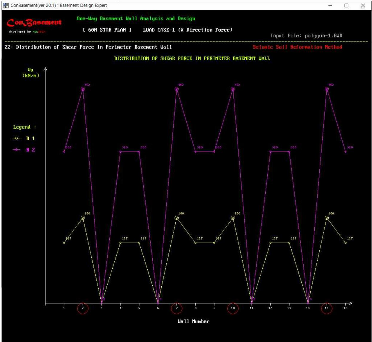
그림4-2. ConBasement의 X방향 하중에 의한 전단력 분포 Vu(kN/m)
