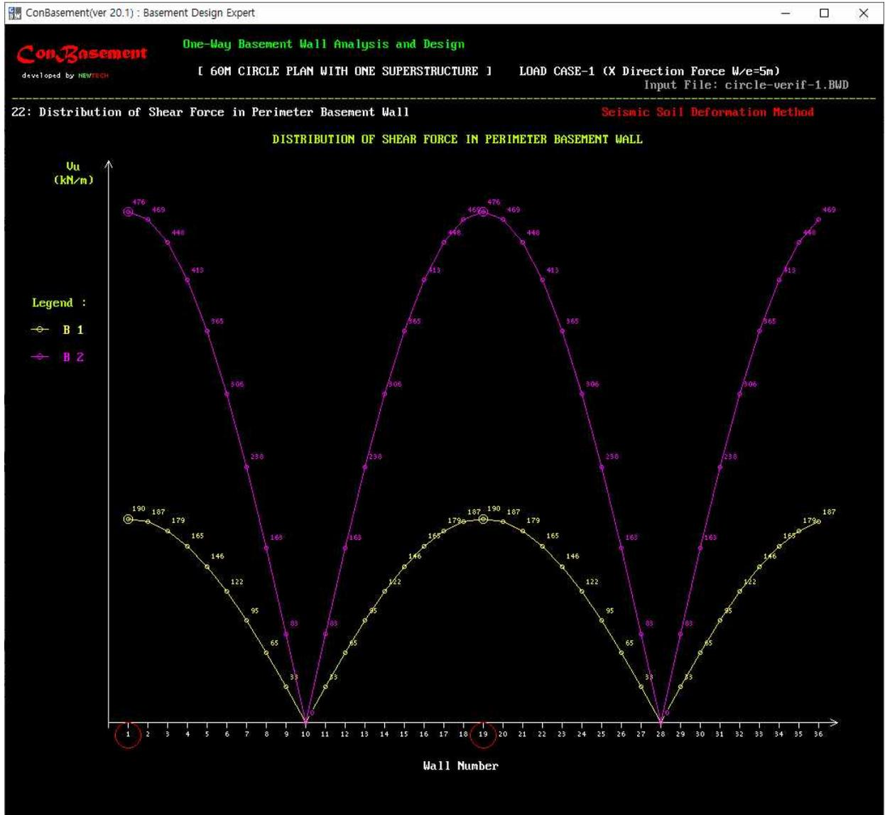
그림1-2. ConBasement의 X방향 하중에 의한 전단력 분포 Vu(kN/m)
